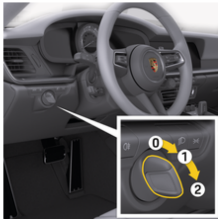
рис. 68: Положення ключа в замку запалювання
