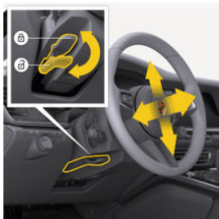
рис. 46: Важіль регулювання положення кермового колеса
