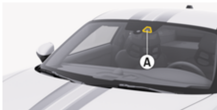
рис. 75: Камера на вітровому склі
