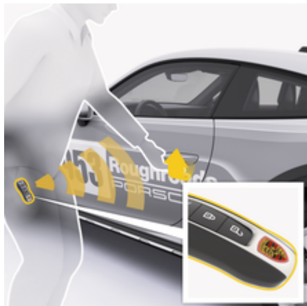
рис. 17: Відмикання дверей за допомогою системи комфортного доступу
