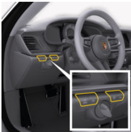
рис. 73: Панель керування освітлювальними приладами
