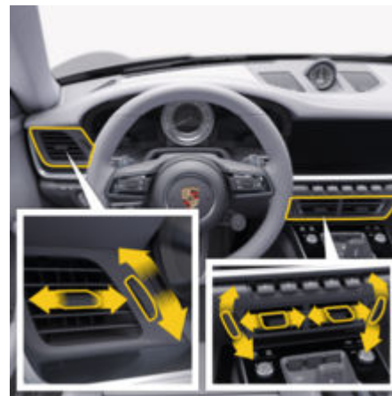
рис. 41: Регулювання положення дефлектора
