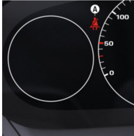
рис. 52: Індикація стану ременя безпеки на комбінованій панелі приладів
