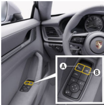
рис. 5: Кнопки склопідйомника у дверях водія
