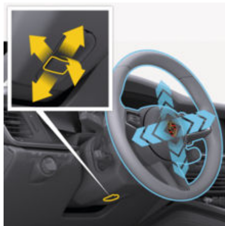
рис. 47: Перемикач для регулювання кермового колеса
