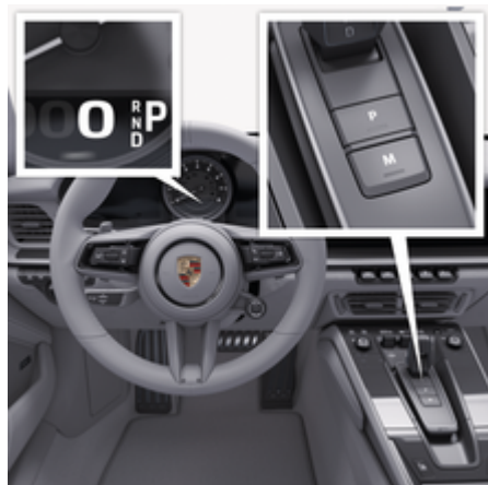
рис. 70: Увімкнення блокування коробки передач
