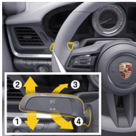
рис. 76: Увімкнення покажчиків поворотів, дальнього світла й переривчастого світлового сигналу
