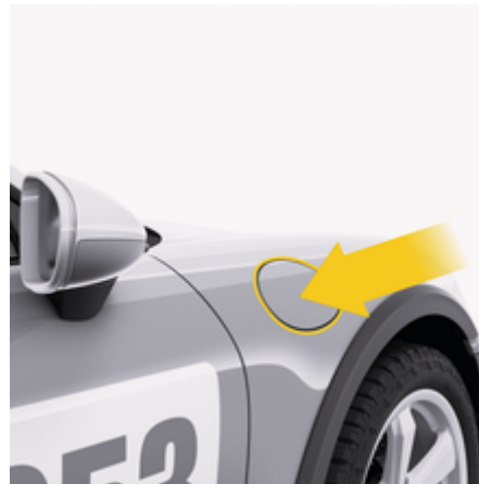
рис. 177: Відкривання кришки паливного бака
