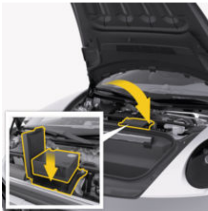
рис. 143: Вкладання компресора для накачування шин
