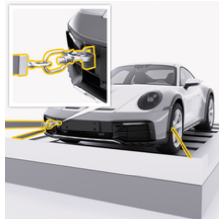
рис. 162: Прив'яжіть автомобіль до платформи
