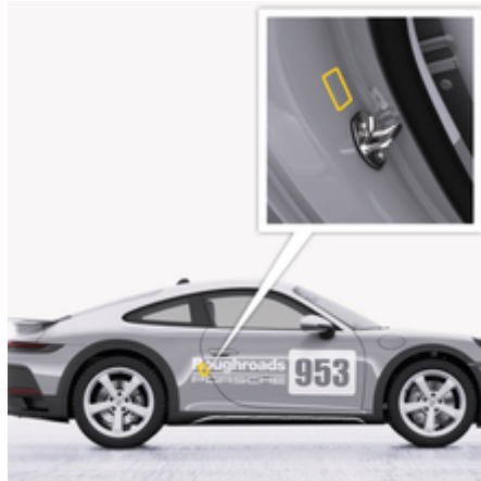
рис. 184: Розташування заводської таблички із зазначенням моделі
