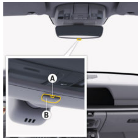
рис. 61: Автоматичне затемнення внутрішнього дзеркала заднього виду
