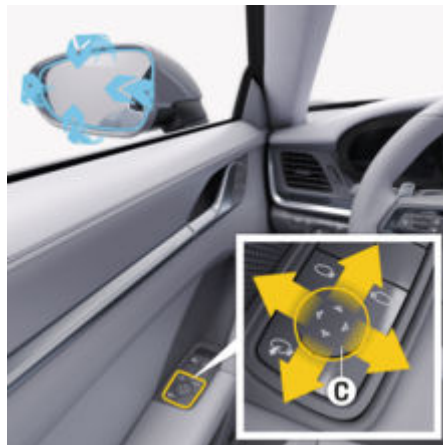
рис. 58: Регулювання положення зовнiшнiх дзеркал заднього виду
