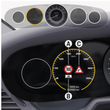
рис. 92: Індикатор дорожніх знаків на комбінованій панелі приладів
