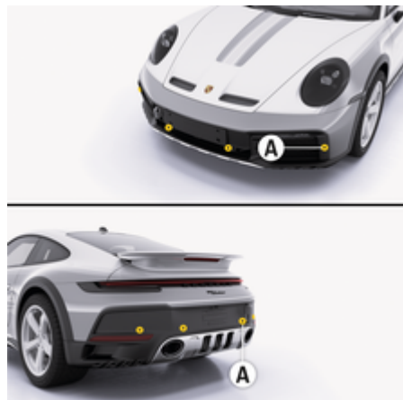
рис. 79: Ультразвукові датчики для вимірювання відстані
