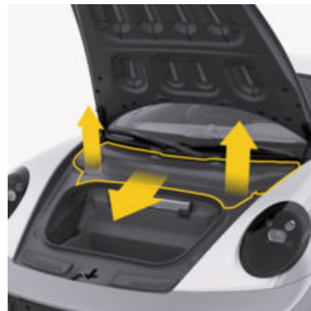
рис. 141: Розблокування та підняття пластикової обшивки
