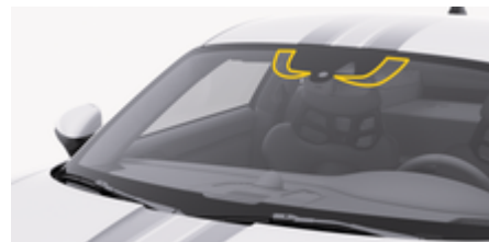
рис. 111: Кріплення пристроїв оплати дорожнього мита
