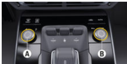
рис. 97: Регулятор гучності та поворотно-натискна кнопка
