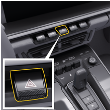
рис. 77: Увімкнення та вимкнення світлової аварійної сигналізації
