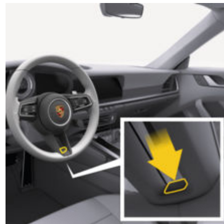
рис. 48: Кнопка обігрівання кермового колеса
