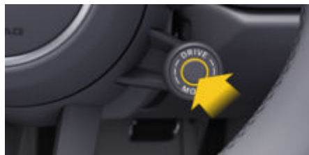
рис. 66: Кнопка SPORT Response на кермовому колесі
