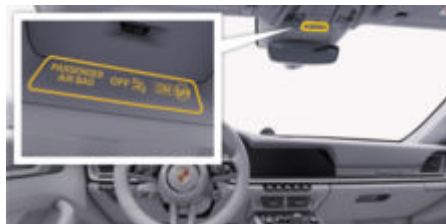
рис. 24: Індикатор ПОДУШКА БЕЗПЕКИ ПАСАЖИРА ВИМКНЕНА/УВИМКНЕНА (PASSENGER AIR BAG OFF/ON)
