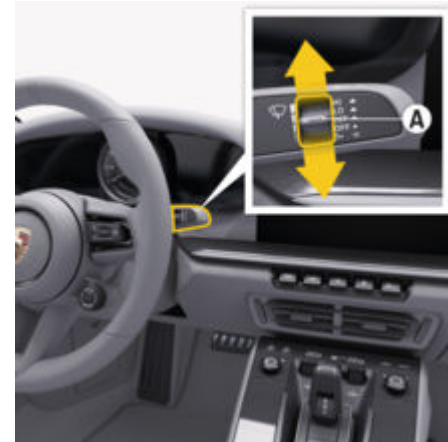
рис. 89: Перемикач А режиму роботи з інтервалами або з керуванням від датчика дощу
