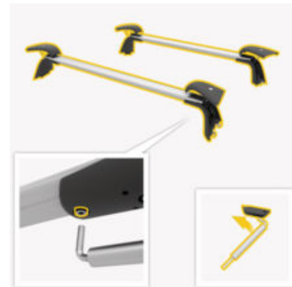
рис. 129: Ослаблення гвинтів із нижнього боку траверс
