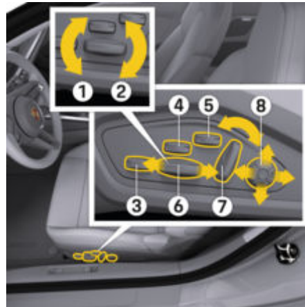
рис. 54: Регулювання положення адаптивного спортивного сидіння Sport Plus
