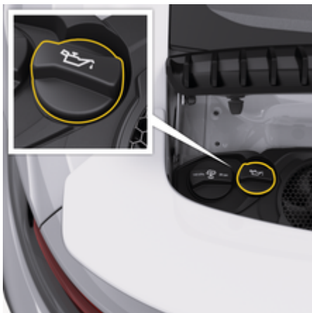
рис. 168: Відкриття кришки оливозаливної горловини
