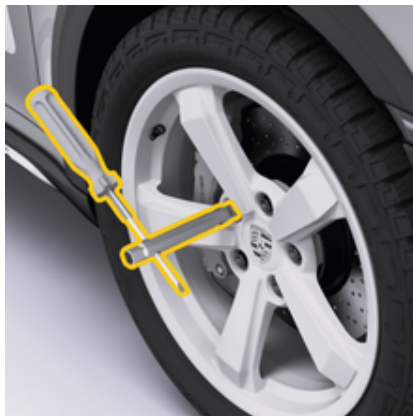
рис. 175: Вкрутити допоміжний пристрій для складання
