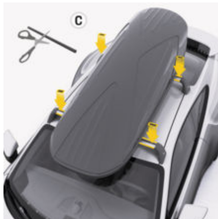
рис. 134: Підрізання та кріплення зовнішніх профілів
