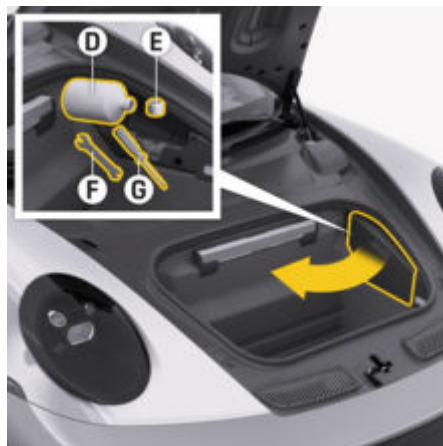
рис. 140: Герметик для шин і бортові інструменти
