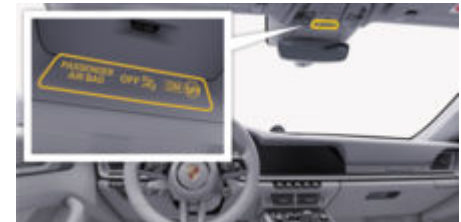
рис. 33: Індикатор ПОДУШКА БЕЗПЕКИ ПАСАЖИРА ВИМКНЕНО/УВІМКНЕНО (PASSENGER AIR BAG OFF/ON)
