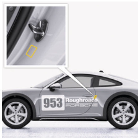
рис. 186: Розташування таблички із зазначенням норм тиску в шинах
