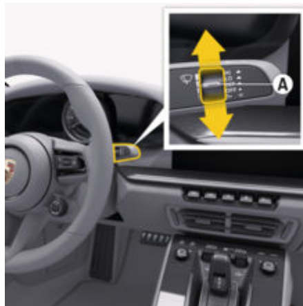
рис. 87: Перемикач А регулятора чутливості датчика дощу / періодичного режиму роботи
