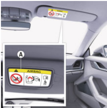
рис. 27: Попереджувальна наклейка щодо подушки безпеки на сонцезахисному козирку
