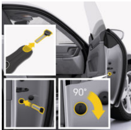
рис. 22: Аварійне блокування дверей переднього пасажира
