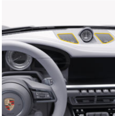
рис. 42: Налаштування для верхньої зони обдування
