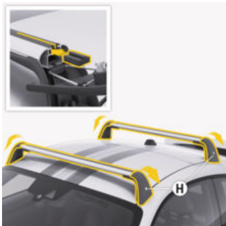
рис. 133: Установлення насадочних модулів
