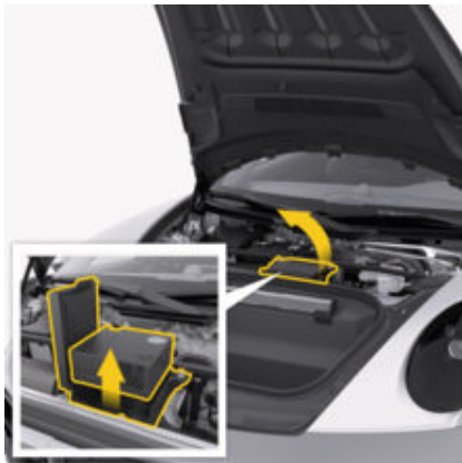
рис. 142: Відкривання відділення компресора для накачування шин
