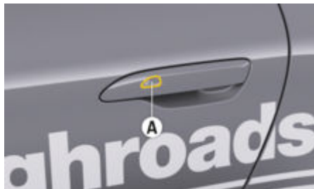
рис. 19: Замикання дверей за допомогою системи комфортного доступу
