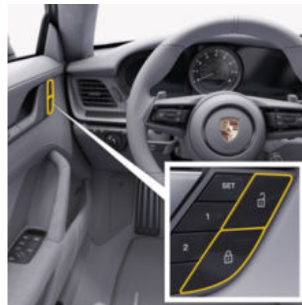
рис. 18: Кнопка центрального замка в оббивці дверей
