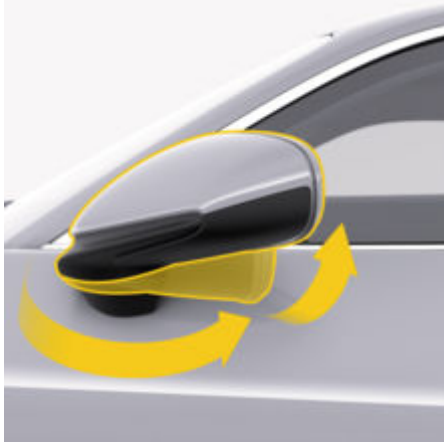
рис. 59: Складання та розкладання зовнішніх дзеркал заднього виду
