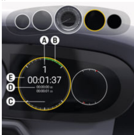
рис. 114: Секундомір на комбінованій панелі приладів
