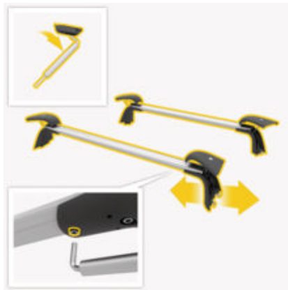
рис. 131: Затягування гвинтів із нижнього боку траверс
