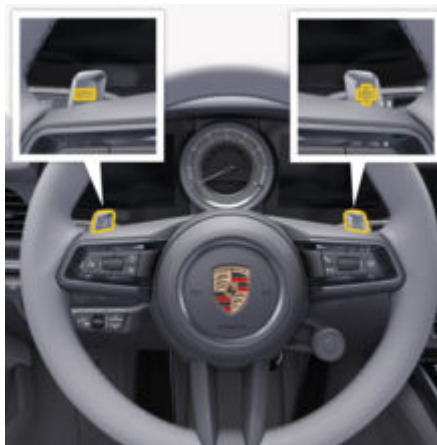
рис. 72: Кермове колесо з пелюстками перемикання передач
