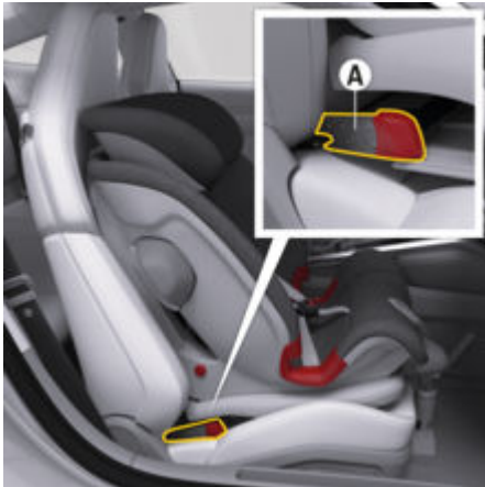
рис. 35: Установлення дитячої утримувальної системи з опорною стійкою
