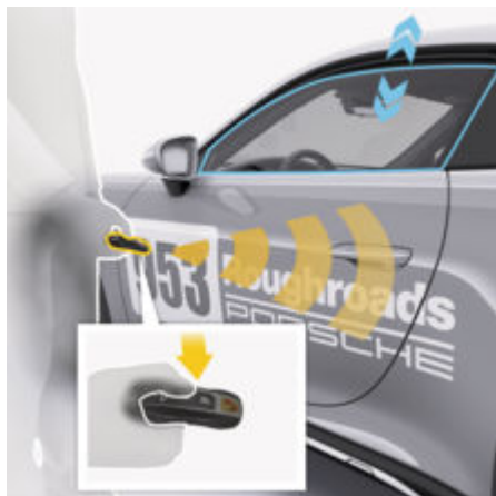
рис. 6: Опускання та піднімання стекол за допомогою автомобільного ключа
