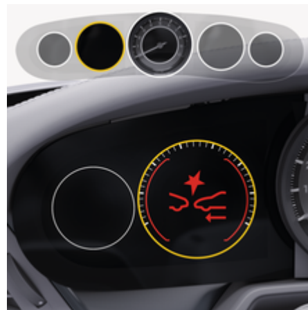
рис. 93: Попередження про небезпеку зіткнення на комбінованій панелі приладів
