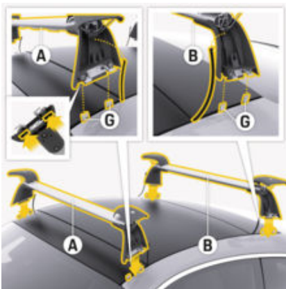
рис. 130: Регулювання довжини траверси
