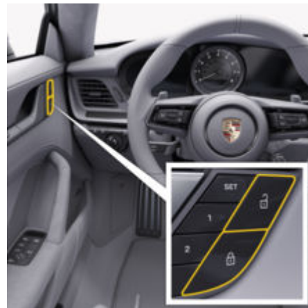
рис. 20: Кнопка центрального замка в оббивці дверей
