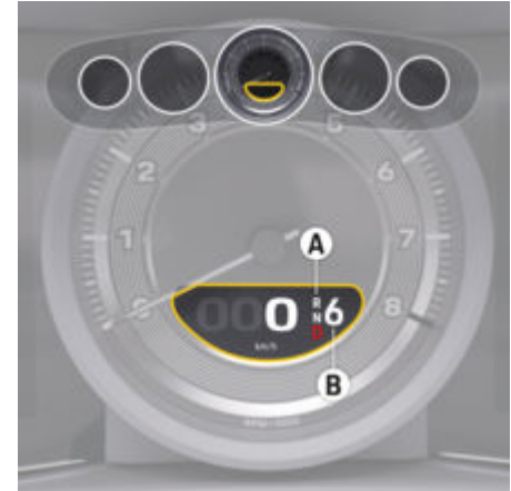
рис. 69: Індикатор режиму роботи й увімкненої передачі
