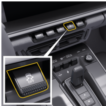
рис. 83: Кнопка PSM OFF на кнопковій панелі
