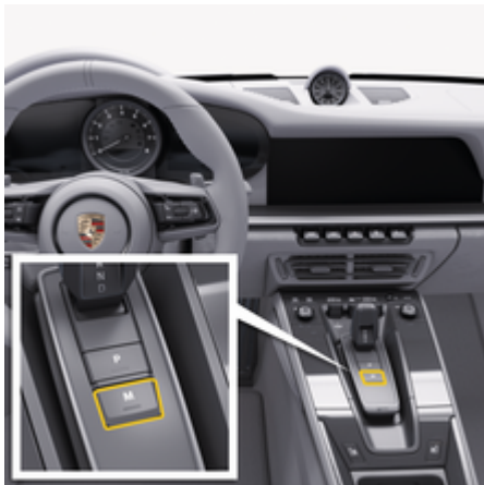
рис. 71: Ручний режим перемикання передач
